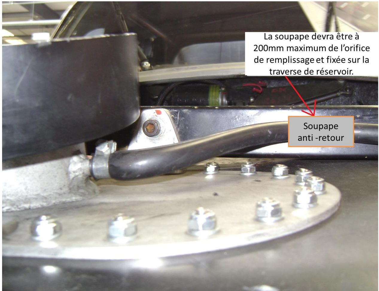
La soupape devra être à 200mm maximum de l'orifice de remplissage et fixée sur la traverse de réservoir.
